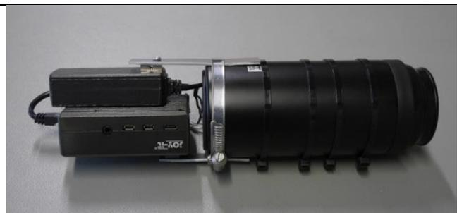
Die Akustikfalle: links ist die Technischeinheit, rechts der Auffangbehälter.
